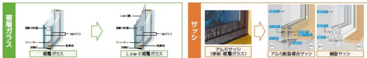
目標基準値：複層ガラスは中空層厚みに応じて設定。サッシは窓面積に応じて設定。
