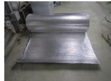
写真-12 両面アルミ反射シート
